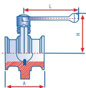
CONSTRUIDAS EN CUERPO DE ACERO DE ACERO INOXIDABLE T-304 Ó T-316 EMPAQUE DE EPDM O SILICÓN, CON CAPACIDAD DE 10 KM/CM2 A UNA TEMP. DE 100°C 3 Ó 12 POSICIONES
