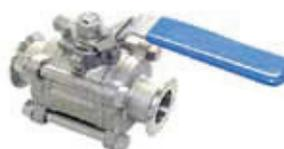
VÁLVULA DE BOLA DE ACERO INOXIDABLE TIPO-316L SANITARIA EXTREMOS CLAMP. DISPONIBLES DESDE 1/2" HASTA 4" CLAMP EN SUS MODELOS DE 2 Y 3 PIEZAS.
